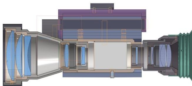
Рис. 5. Модель биноклярного ПНВ в разрезе
