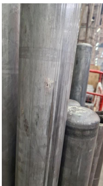
Рис. 7. Пятна голого металла на изделии
