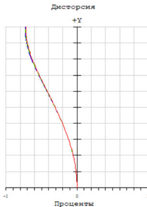
Рис. 5. Дисторсия объектива в процентах
