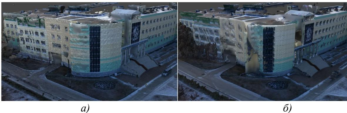
Рис. 2. Трехмерная модель, построенная по данным: а) аэрофотосъемки; б) лазерного сканирования
