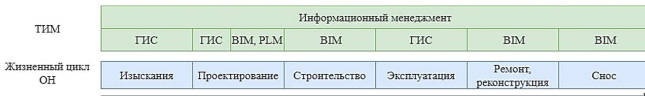
Рис. 2. Технологическая схема использования BIM, ГИС, PLM на разных этапах жизненного цикла ОН
