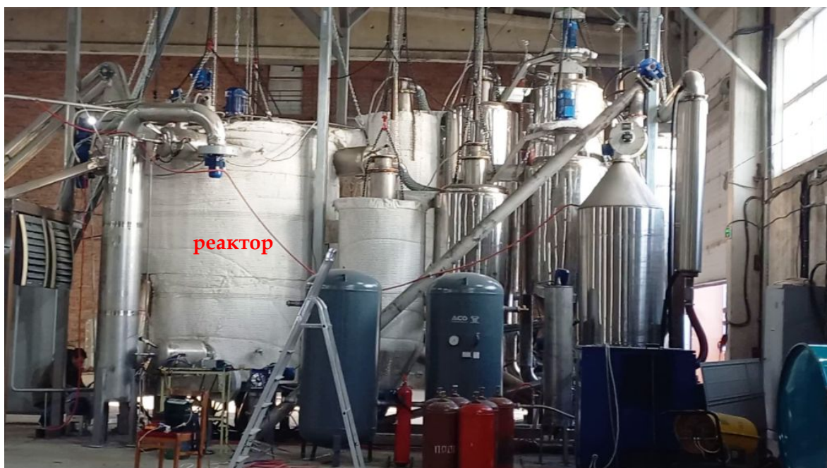
Рис. 3 Реактор быстрого пиролиза компонентов ТКО
