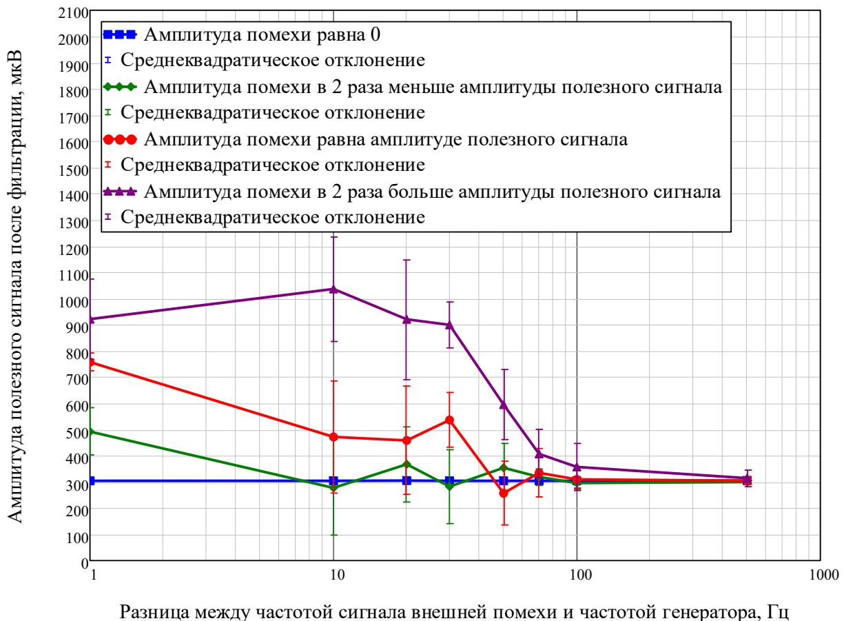
Рис. 3. Результат влияния внешней помехи. Показано, что если частота помехи отличается от частоты генератора больше чем на 30 Гц, то помеха перестает влиять на измерение
