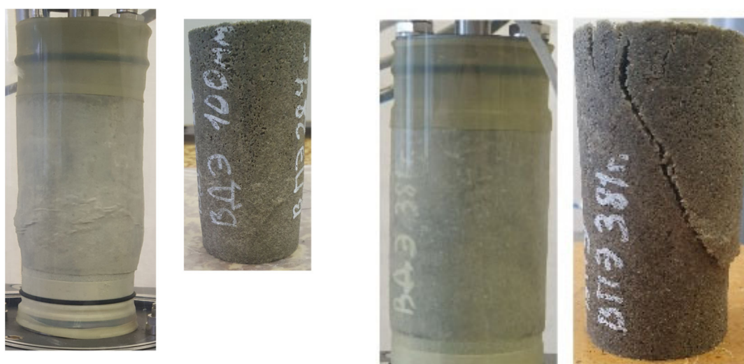
Рис. 2. а. Диаграммы «вертикальное нагружение – деформация» образцов пропитанного песка с объемной долей высокоэластичной полиуретановой смолы 1 - 20 об. % и быстродействующей смолы 2 - 5 об. %, 10 об. %, полученные при испытаниях на трехосное сжатие. Содержание смолы 1 и смолы 2: черный цвет - 20 об. % и 5 об. %; голубой цвет - 20 об. % и 10 об. %; серый цвет - 20 об. %. б. Образец мелкозернистого песка, пропитанного полиуретановой смолой 1 с объемным расходом 20 об. %: слева – в процессе, справа - после эксперимента на трехосное сжатие. в. Образец мелкозернистого песка, пропитанного полиуретановыми смолами 1 и 2 с объемными долями 20 об. % и 5 об. %: слева – в процессе, справа - после эксперимента на трехосное сжатие.
