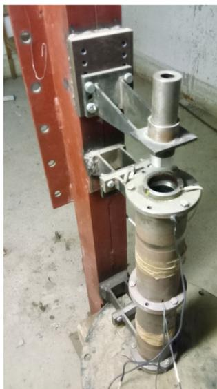
Рис. 4. Стенд с моделью электромагнитного молота
