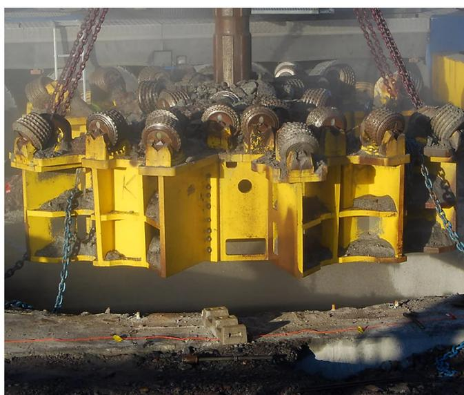
Рис. 3. Расширитель, производимый компанией Atlas Copco
