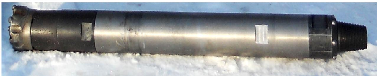
Рис. 3. Экспериментальный образец погружного пневмоударника ПВ130
