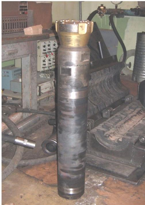
Рис. 2. Пневмоударник с импортной коронкой SPEED Ø165 мм
