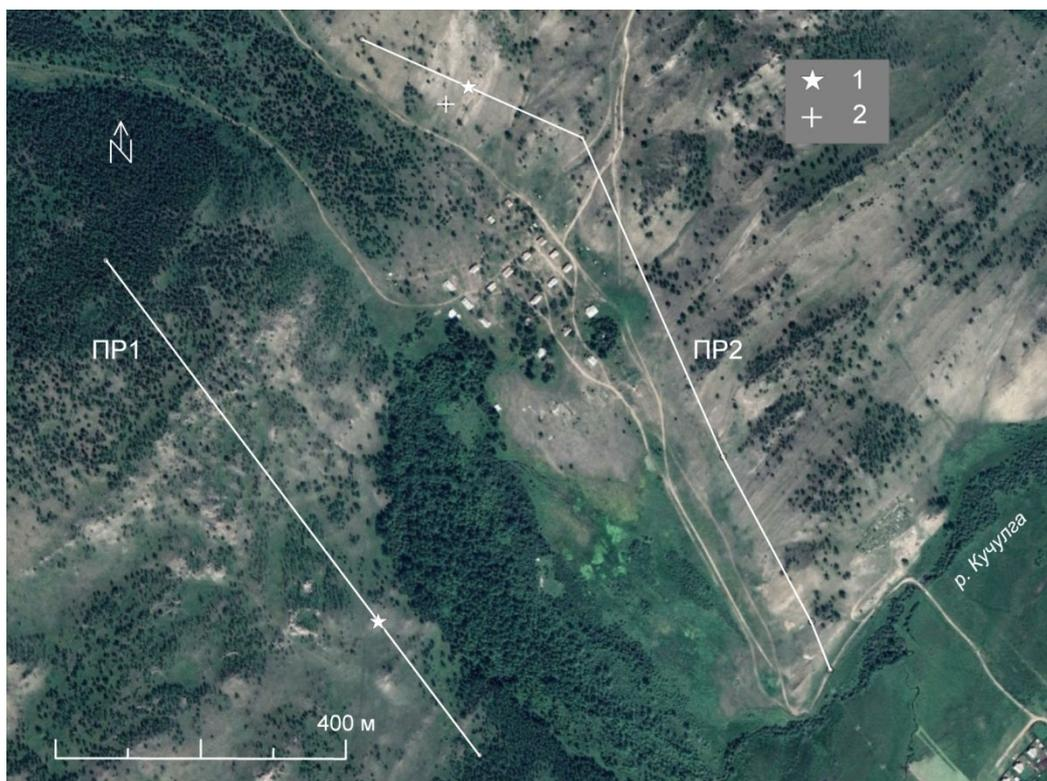
Рис. 1. Падь Барун-Хал, база учебных геолого-геофизических практик ИрНИТУ и геофизические профили: 1 – место на профиле, где наблюдается отрицательная аномалия ЕП большой амплитуды и положительная магнитная аномалия; 2 – положение центра установки зондирования методом переходных процессов
