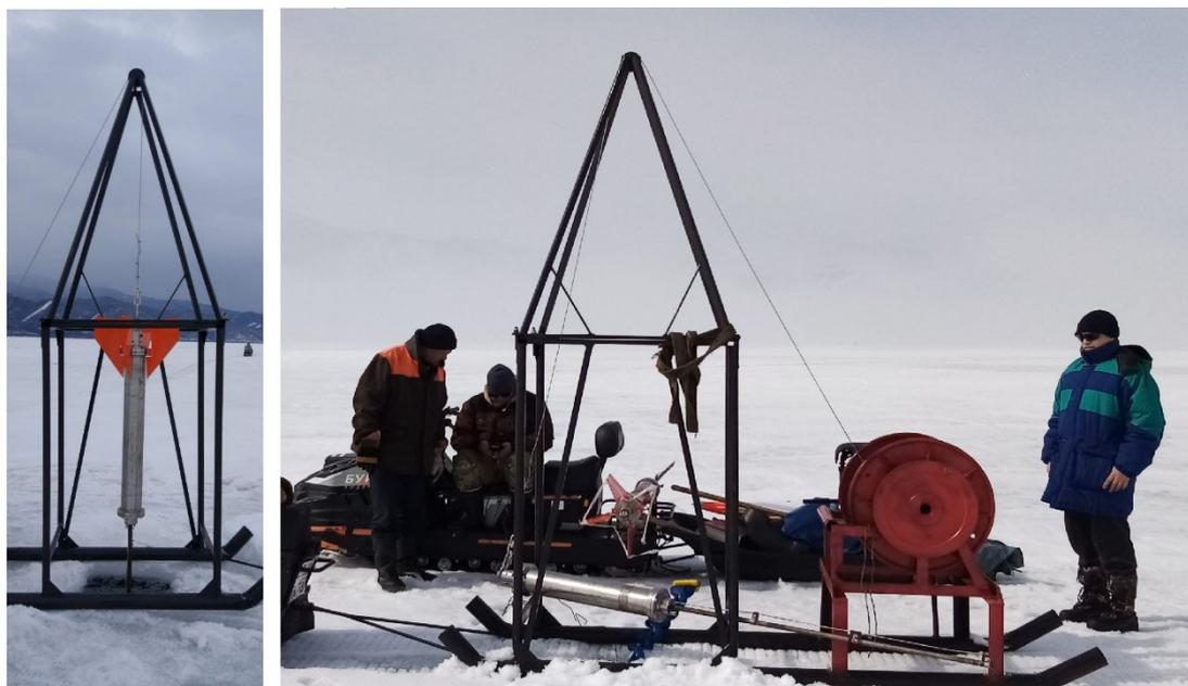
Рис. 1. Установка для погружения зонда-термографа со льда (в стартовом рабочем положении и общий вид)
