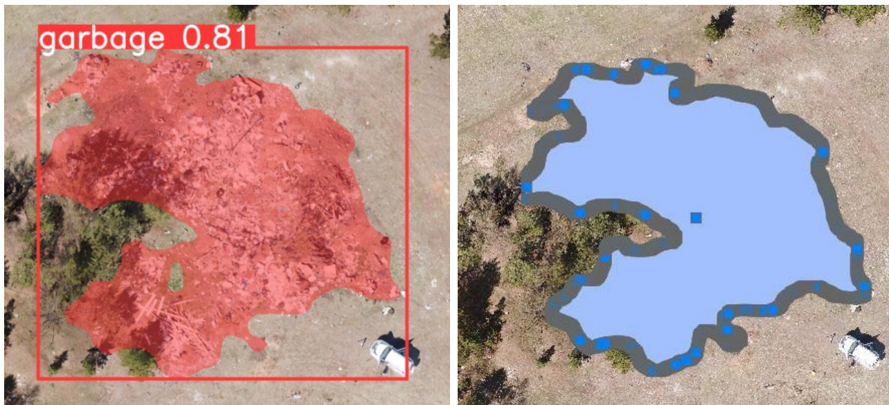
Рис. 4. Контур блока 5 свалки, выделенный нейросетью после обучения
