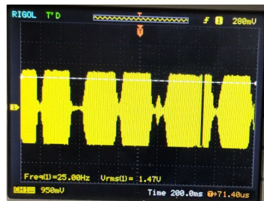
Рис. 12. Осциллограмма с приемника при прохождении газовых снарядов Тейлора в канале
