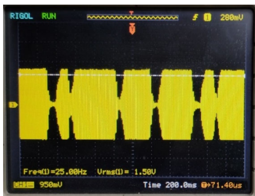
Рис. 11. Осциллограмма при прохождении крупных пузырей в канале
