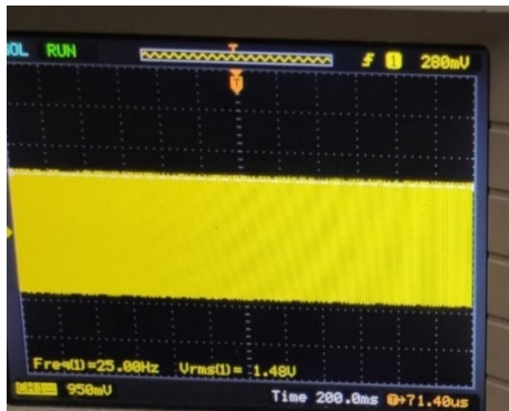
Рис. 9. Осциллограмма сигнала в отсутствие газовой фазы в канале
