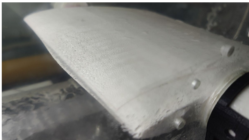
Рис. 3. Фотография наледи на лопасти
