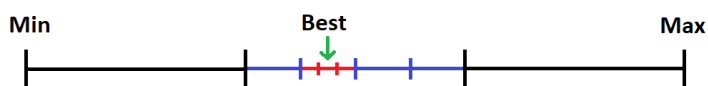
Рис 2. Схема автоматизированного поиска оптимального значения параметра фотоприемника с итеративным разбиением и сужением интервала поиска
