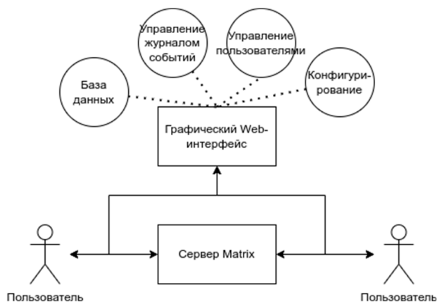
Рис. 4. Реализация сервера с web-интерфейсом
