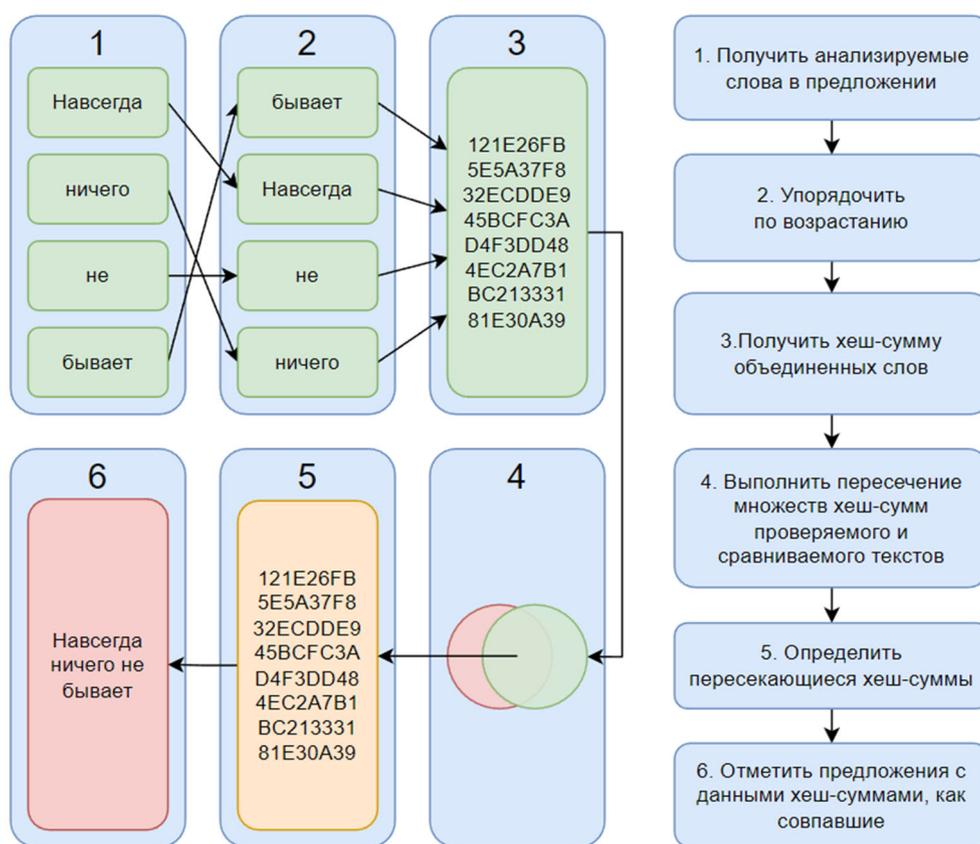
Рис. 2. Алгоритм определения точных совпадений
