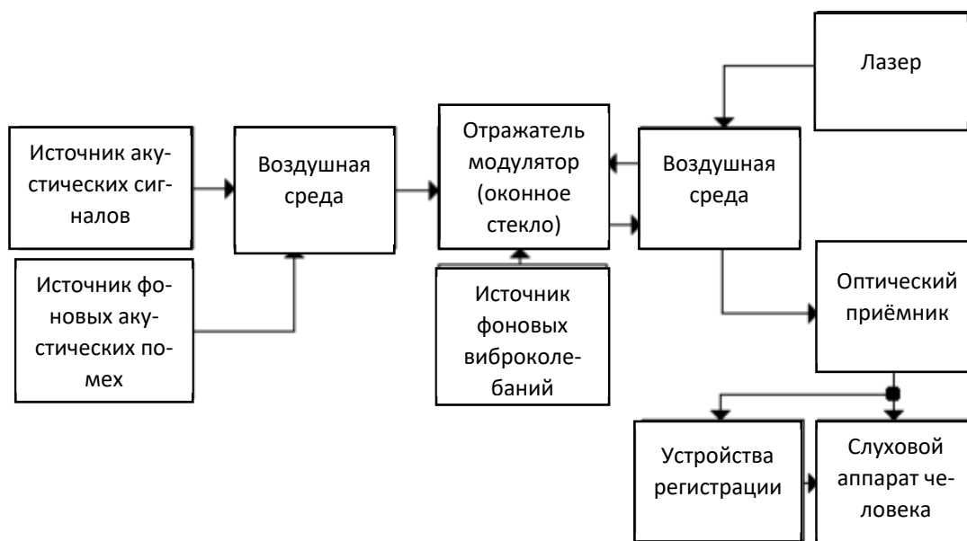
Рис. 1. Обобщенная схема утечки информации по оптико-акустическому каналу
