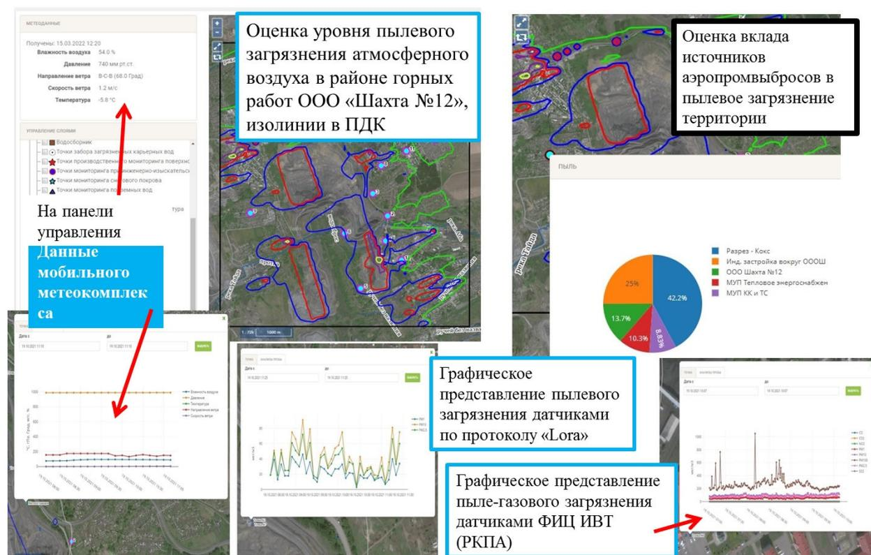
Рис. 2. Пример работы программно-аппаратного комплекса мониторинга загрязнения атмосферного воздуха в режиме текущего (реального) времени
