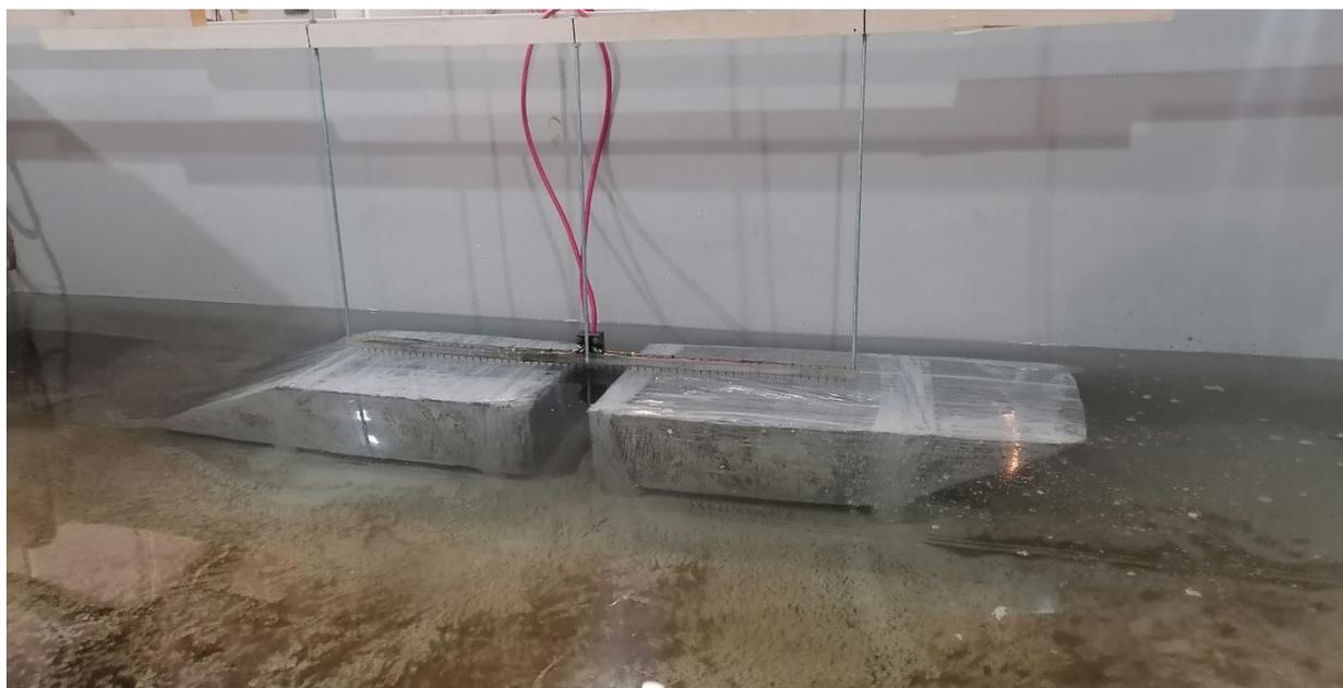
Рисунок 2. Модель вертикальной разломной зоны в бассейне с водой.
