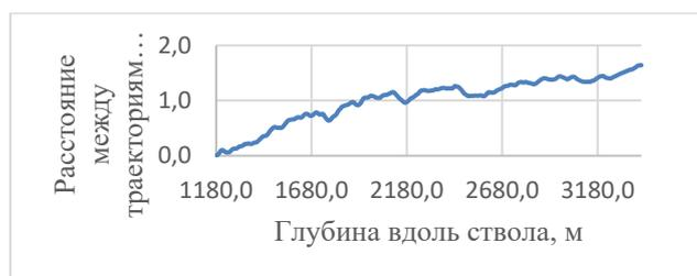
Рис. 4. Зависимость расстояния между траекториями прибора А и прибора Н от глубины
