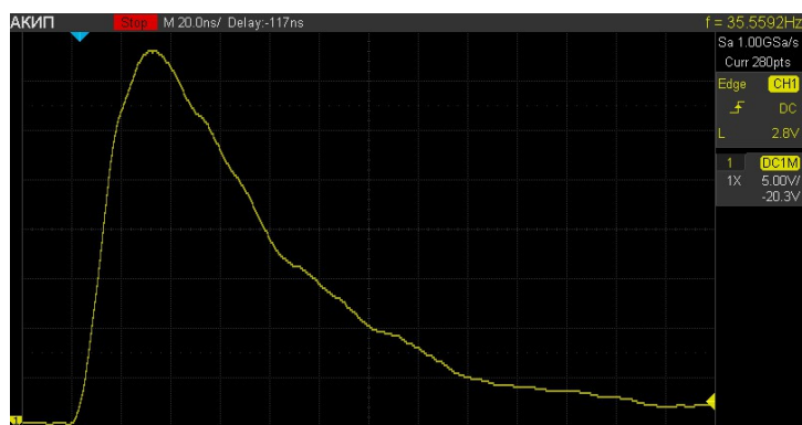
Рис. 8. Импульс 240 нс. Максимальное значение тока 15 А
