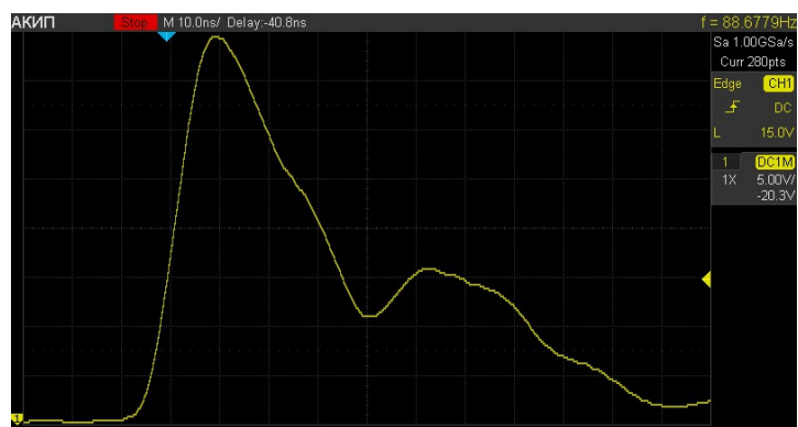
Рис. 9. Импульс 110 нс. Максимальное значение тока 6.5 А
