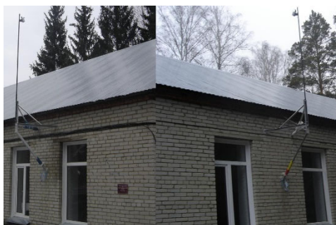
Рис. 4. Расположение снегомеров над крышей здания станции космических лучей
