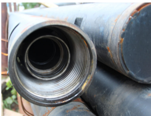
Рис. 2. Двойные буровые трубы шведской компании Atlas Copco
