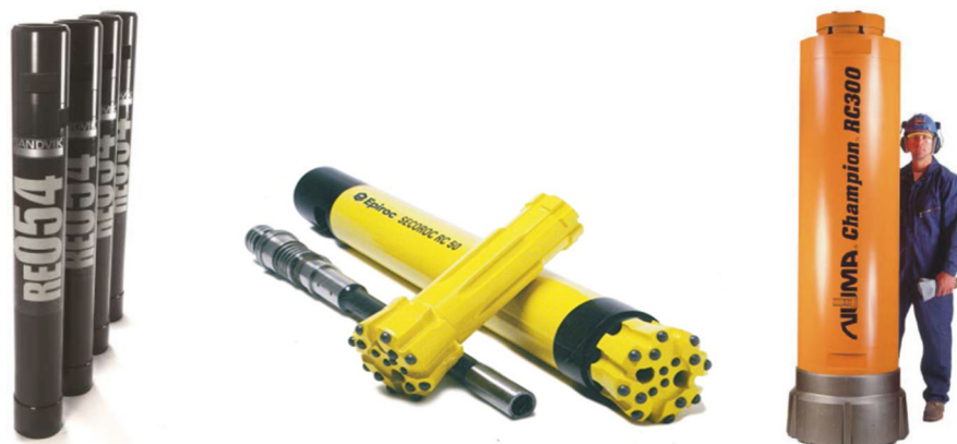
Рис. 7. Зарубежные пневмоударники с центральным шламотранспортом
