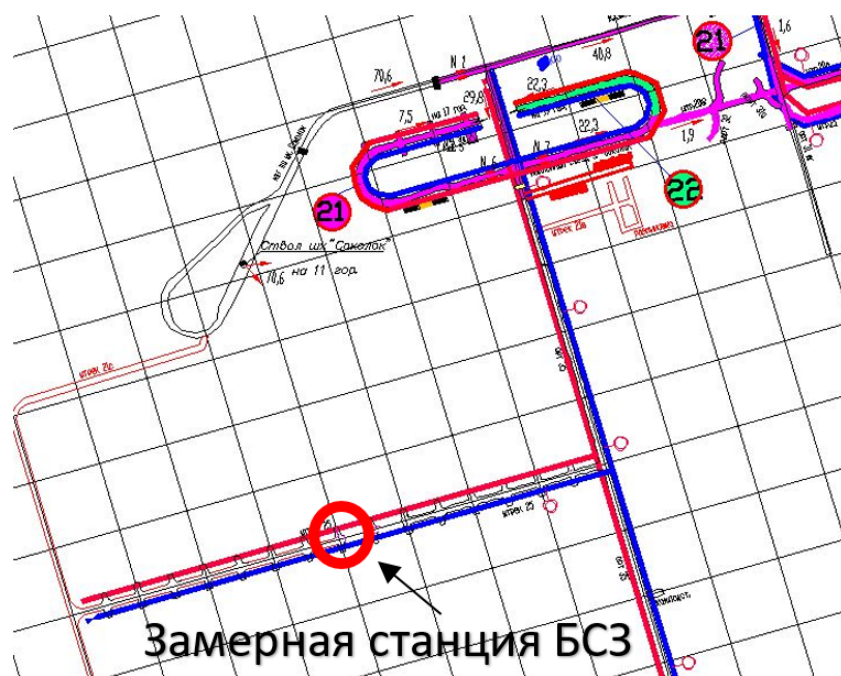
Рис 1. Схема расположения замерной станции БСЗ в плане
