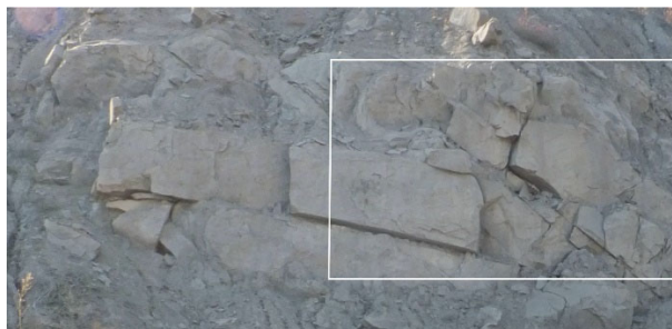
Рис. 1. Фрагмент разрушений аргиллитов на склоне борта угольного разреза
