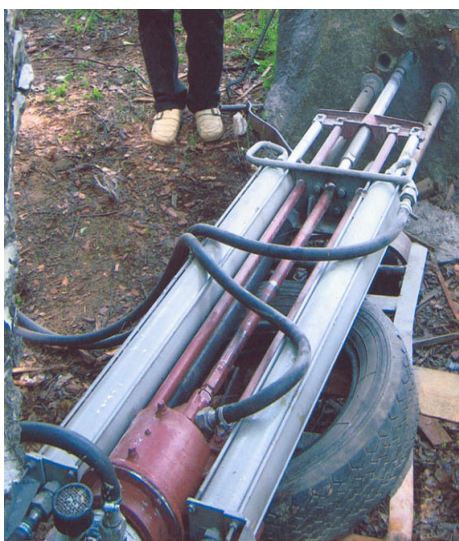
Рис. 5. Экспериментальное определение параметров малогабаритного пневмоударника
