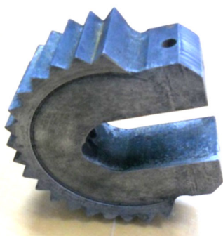
Рис.2. Экспериментальный образец породоразрушающего инструмента для проходки скважин прямоугольного сечения.
