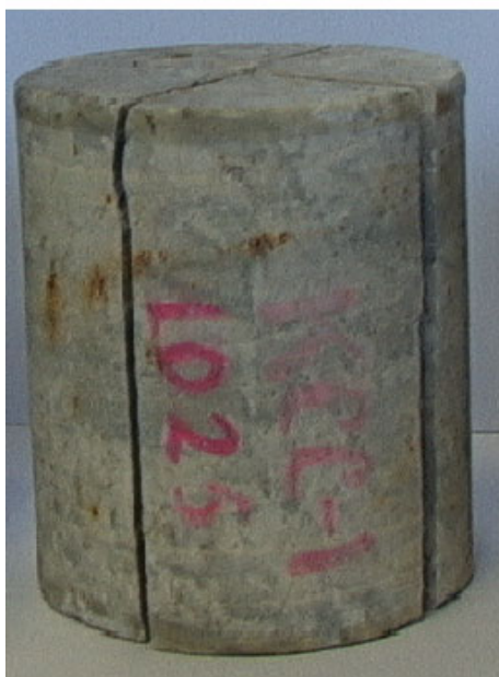
Рис. 4. Направления разрушения на образце известняка
