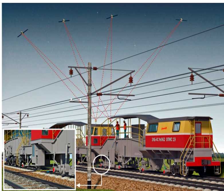
Рис. 5. ЭЛБ-4С, оснащенный САУ-3D
