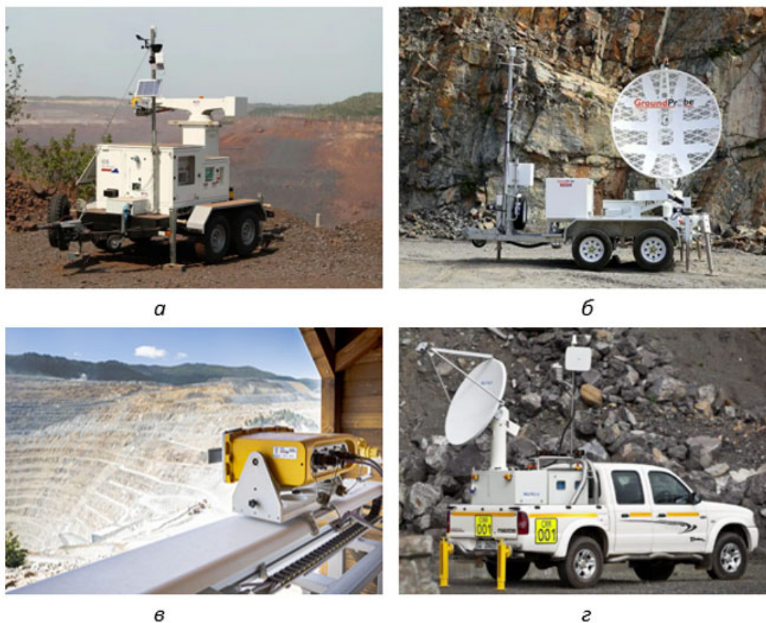
Рис. 2. Варианты исполнения георадаров:
