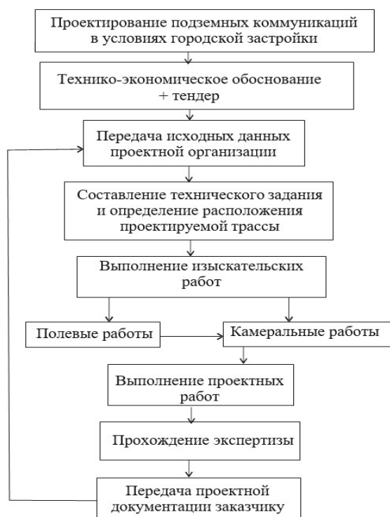
Рис. 1. Схема проектирования подземных коммуникаций в условиях городской застройки
