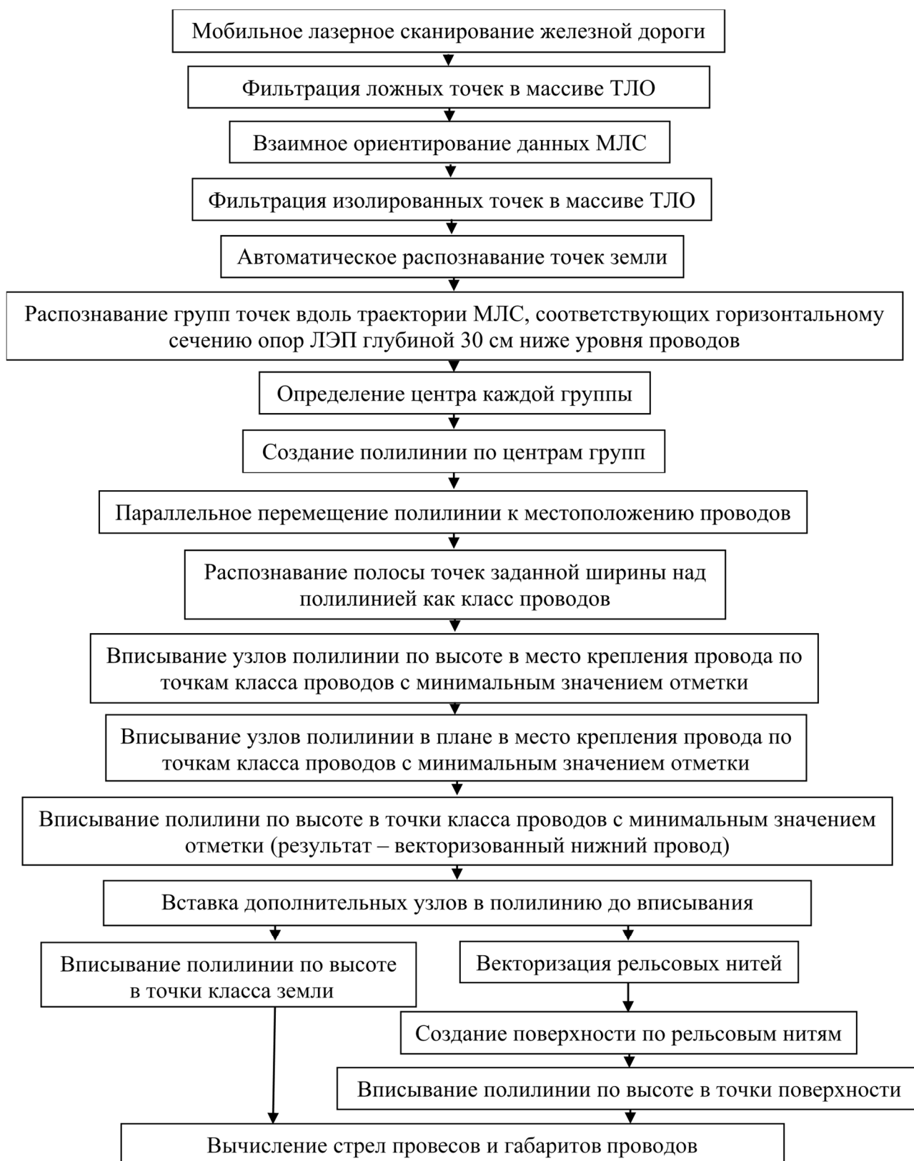
Рис.2. Методика автоматизированного определения стрел провеса и габаритов проводов
