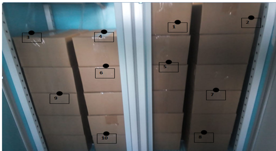
Рис. 3 Схема расположения датчиков для измерения температуры в полезном объеме камеры
