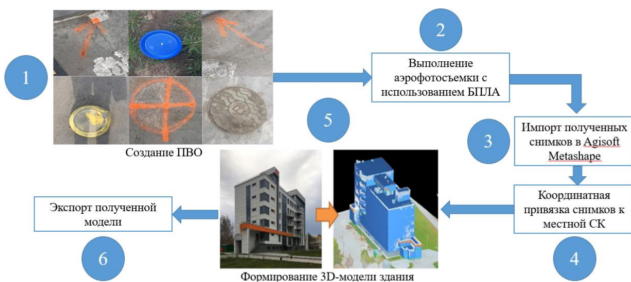
Рис. 4. Основные этапы формирования 3D-модели здания при выполнении фотограмметрических работ методом опорных точек
