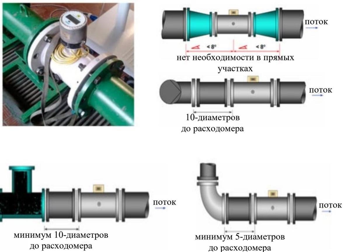
Рис. 4. Требования к установке для различных схем расположения труб.
