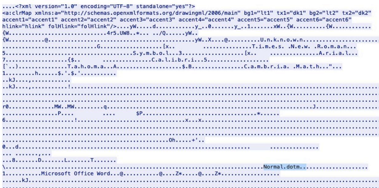
Рис. 4. Пакет с полезной нагрузкой № 1. Загрузка шаблона Normal.dotm
