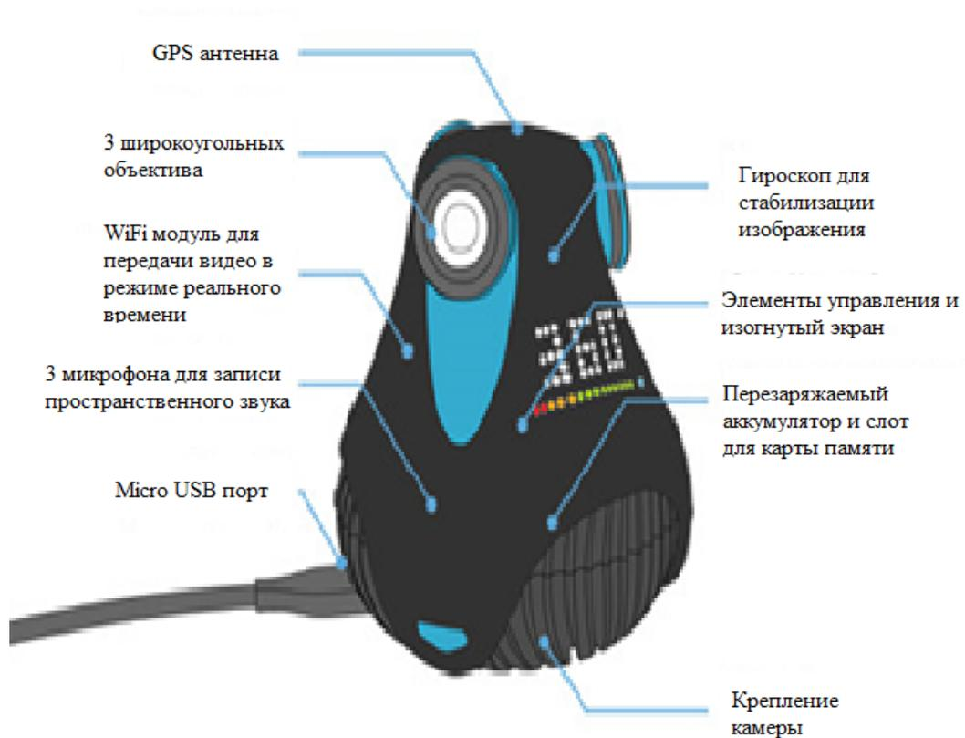
Рис. 1. Внешний вид панорамной камеры The 360cam
