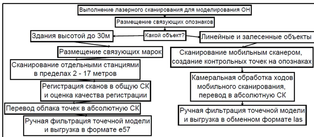
Рис. 3. Схема проведения работ по лазерному сканированию для задач 3D-кадастра
