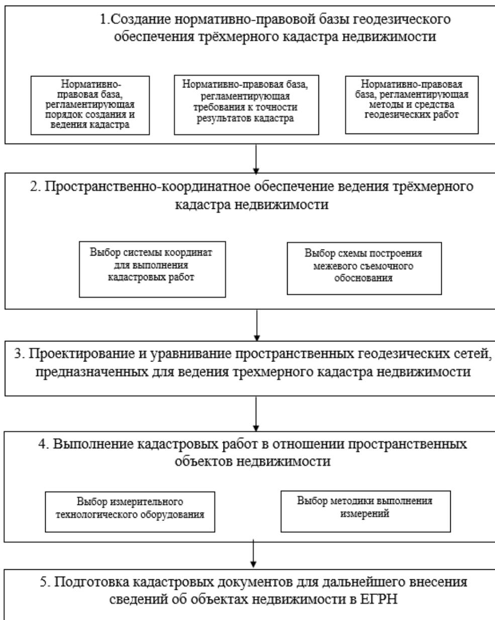
Рис. 1. Технологическая схема создания геодезического обеспечения трехмерного кадастра недвижимости
