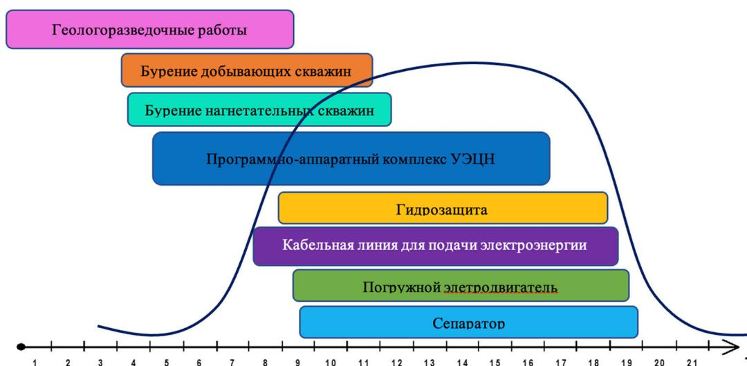
Рис. 3. Схема капитальных затрат использования технологии УЭЦН
