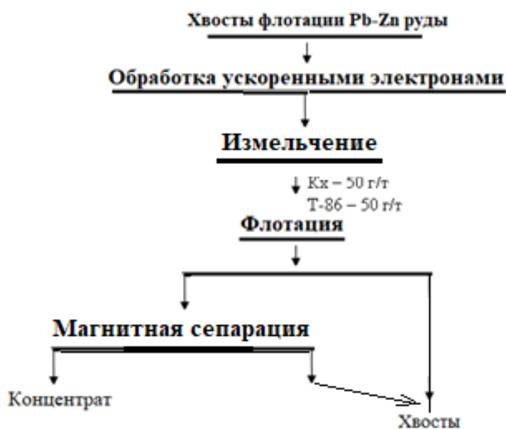
Рис. 1. Технологическая схема рудоподготовки и обогащения хвостов свинцово-цинковой руды
