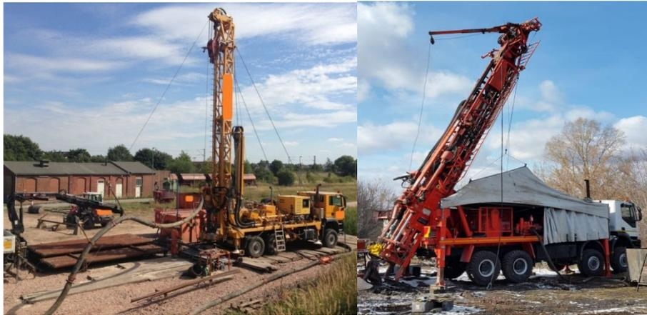
Рис. 1. Буровая установка Prakla RB-50 и Sandvik DE-880
