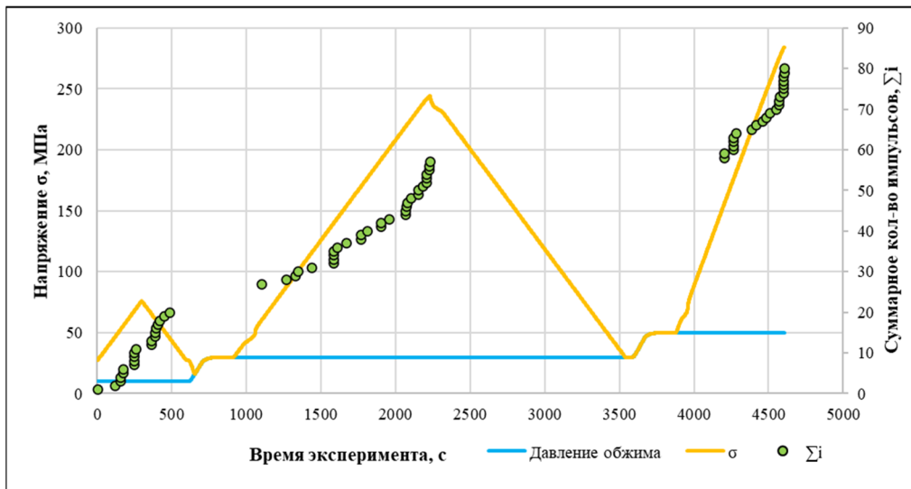
Рис. 5. Зависимость количества зарегистрированных сигналов АЭ от нагрузки при циклическом нагружении образца горной породы
