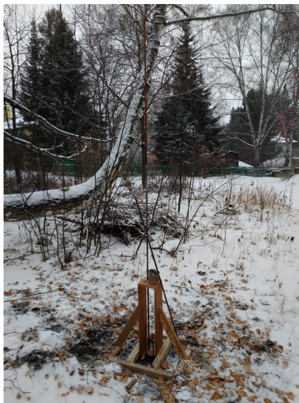
Рис. 2. Фото деревянной направляющей конструкции с забиваемой в землю длиной (>1.5м) штангой
