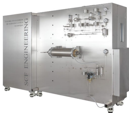
Рис. 4. Установка СКИФ-ФСК для проведения фильтрационных экспериментов на образцах керна
