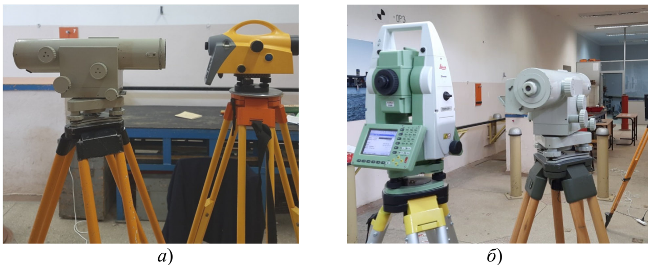
Рис. 1. Схема установки нивелиров (а) и тахеометра (б) в ходе исследований
