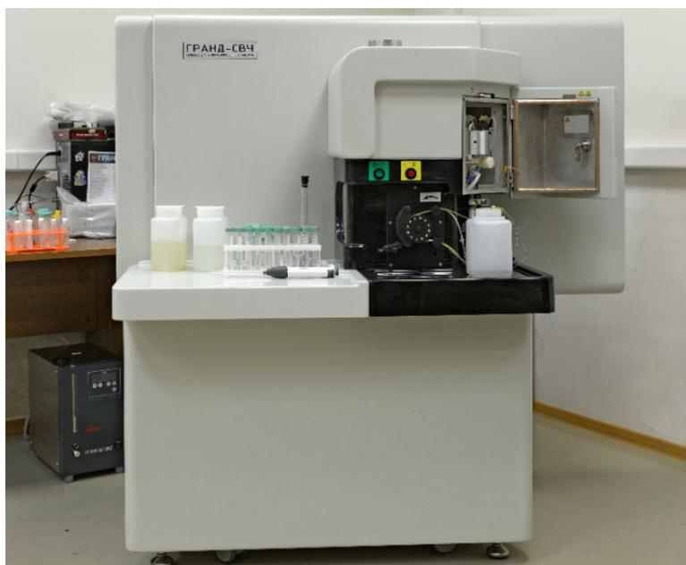
Рис. 1. Внешний вид спектрометра «Гранд-СВЧ»
