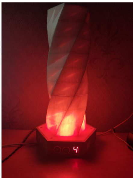
Рис. 4. Отображение расстояния до объекта
